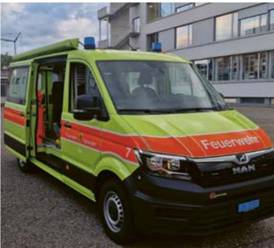
Das PTF SAN dient sowohl dem Personentransport als auch dem Transport von Sanitätsmaterial. Es ermöglicht der Feuerwehr Fällanden die Erstversorgung verletzter Personen und verfügt über Ausrüstung wie Verbandskasten, Defibrillator, Tragen, Decken und ein Zelt. Ein weiteres Highlight ist das integrierte Führungsunterstützungsmaterial, darunter zwei Flipcharts mit Beleuchtung und ein Allwetterdach.
